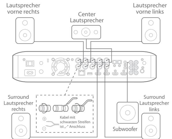
**2 WICHTIG:** Achten Sie darauf, dass die nicht isolierten (+) und (-)-Kabel nicht sich oder andere metallische Gegenstände auf der Rückseite des BDS Receivers berühren. Ein Berühren der nicht isolierten Kabel kann zu einem Kurzschluss und dadurch zu Schäden am BDS Receiver führen.
